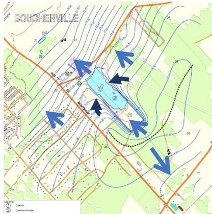
L'eau souterraine entre par 3 parois, et sort par la 4<sup>e</sup> paroi vis-à-vis le chemin d'Anjou. Le pointillé noir est la ligne de partage des eaux. L'eau qui coule vers le chemin de Touraine ne provient pas du dépotoir.
