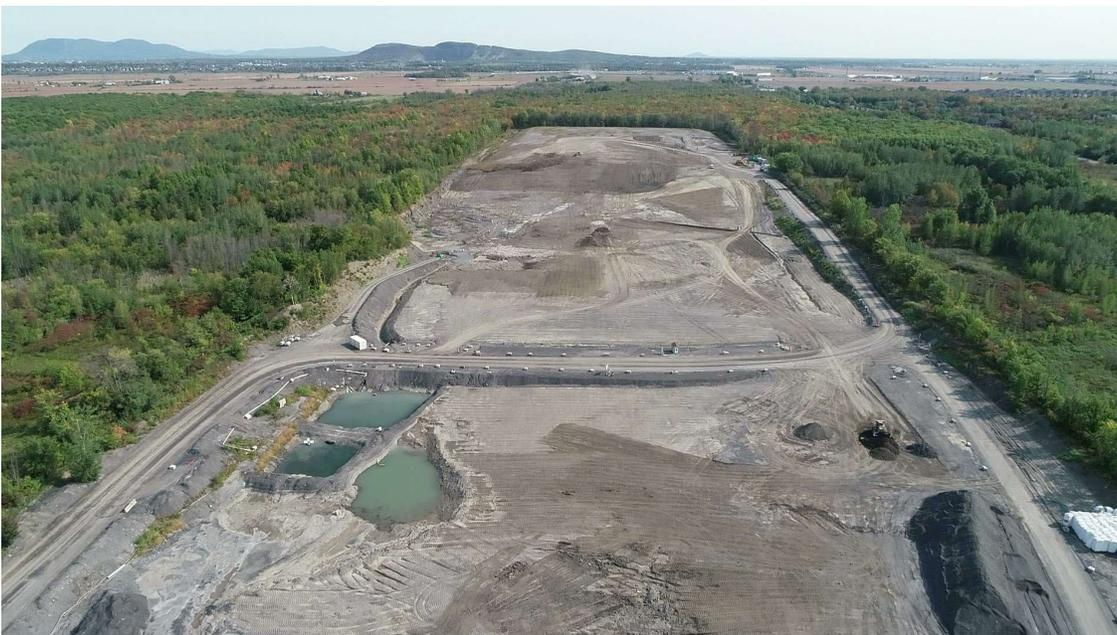
À l'avant, sur la gauche, se trouve le bassin 2 de décantation. Les lignes parallèles qu'on voit sur chemin du site, ce sont des bases de rouleaux compresseurs. La firme d'ingénierie WSP vérifie régulièrement la compaction des sols à ces endroits.
